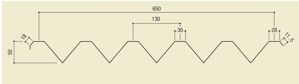
既設のスレート屋根を剥がさずに、屋根上で安全に施工できます。工期の大幅な短縮が可能で、しかも経済的なリフレッシュ工法です。重ね葺き二重構造のため断熱・防音効果が著しく向上します。
